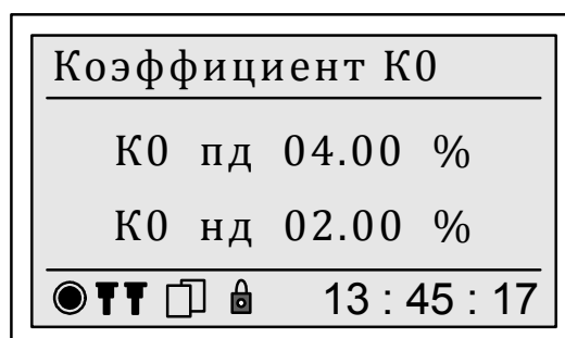
Рисунок 61 – Отображение нормально и предельно допустимых значений коэффициента несимметрии напряжений по нулевой последовательности
